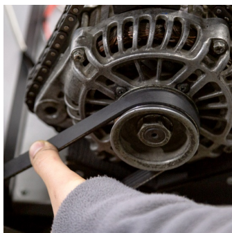
Рисунок 17. Перевірка натягу ремня генератора
