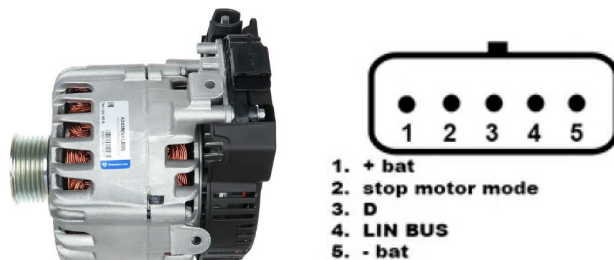
Figura 25. Alternador Valeo IST60C017 y designación de los terminales en el conector
